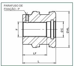
\*Cota AL é referencia para o Ø interno do tubo, não é a cota exata do cabeçote.
